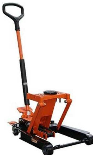
Universeller Wagenheber **aucjh für Motorräder und Quads geeignet**. großes, Fußpedal für guten Zugang in jeder Position; 4 Verriegelungspositionen des Hebearms in verschiedenen Höhen; Spezielle Auflage zur Verwendung mit Motorrädern; Spanngurt zur Sicherung des Motorrads am Wagenheber; Gummiauflagen zum Schutz der Oberflächen und Sicherung vor Verrutschen; Ablagefach, Sicherheitsventil und Sicherheitsablaß.
