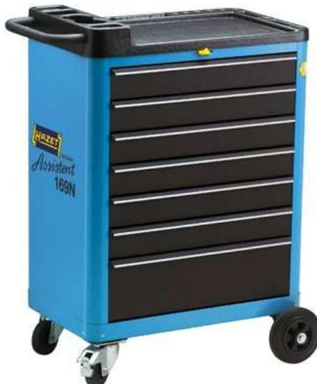
Werkzeug-, Material- und Montagewagen, leer, ohne Werkzeuge. Aus Stahlblech; mit Kunststoff-Oberteil zur Aufnahme von Kleinteilen, Schraubendrehern, Zangen etc.; 6 hoch belastbare Schubfächer inkl. 2 Satz Schubladenunterteilungen; extrem tragfähige Radaufhängung, 4 vollgummibereifte Räder, 2 Lenkräder 100mm 1 feststellbar in Längs- bzw. Querrichtung 2 extra grosse Laufräder 160mm.
