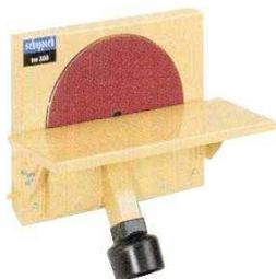
Mit der Tellerschleifeinrichtung tse300 bearbeiten Sie schnell und bequem, Längs- und Stirnkanten, Rundungen und Schrägen bis 150mm. Der Auflagetisch ist für Winkelschleife bis 45° stufenlos verstellbar. Die Schleifblätter werden mittels Klettverschluss einfach gewechselt.
